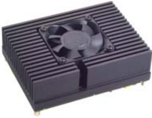
Das COM-Express Module »Toucan« ist mit Core Duo T7400 (Merom), AMT-1.0-Support und aktiver Kühlung ausgestattet.
